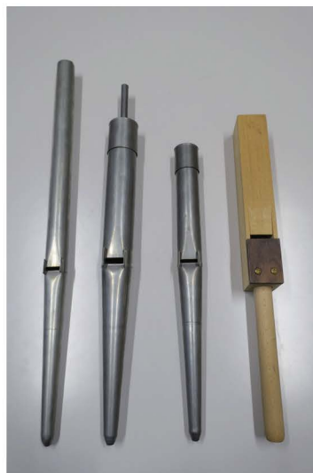
写真4 様々なフルーパイプのサンプル 左からプリンシパル、ロールフレーテ、ゲダクト、ホルツゲダクト
