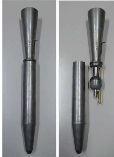
写真3-1,2 リードパイプ
